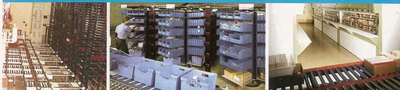
1. Transelevador con cabecera de picking. 2. Carrusel o Armario Horizontal, con mesa de pick to light para preparación multipedidos. 3. Paternoster o Armario Vertical.
