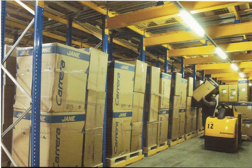
Personal realizando la preparación de un pedido mediante carretilla preparadora con sistema de radiofrecuencia.
