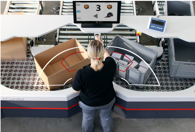
Estación de picking con pantalla indicadora de posición y cantidad. Fuente: TGW.
