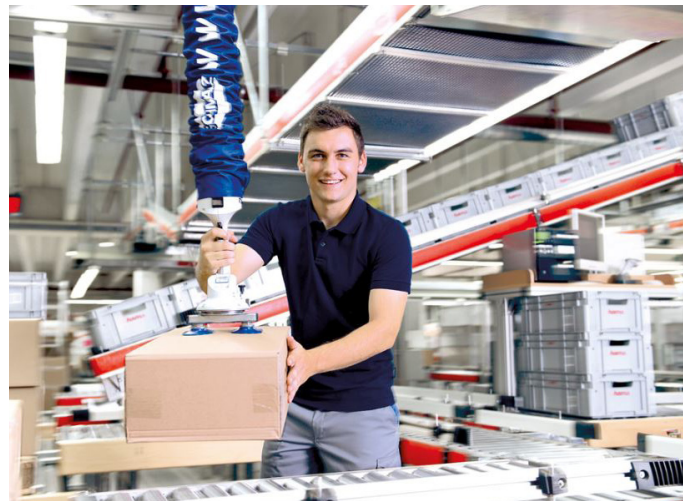
Manipulador ingrávido de cargas. Fuente: SCHMALZ.
