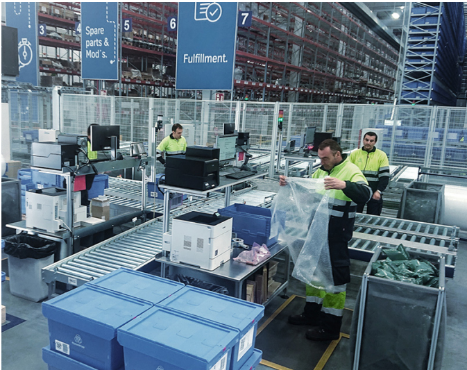
Estación de picking sistema "Producto a hombre". Fuente: VIASTORE.
