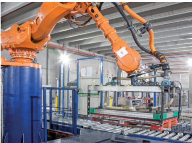
Puesto de preparación de pedidos asistido por robot. Fuente: MECALUX.
