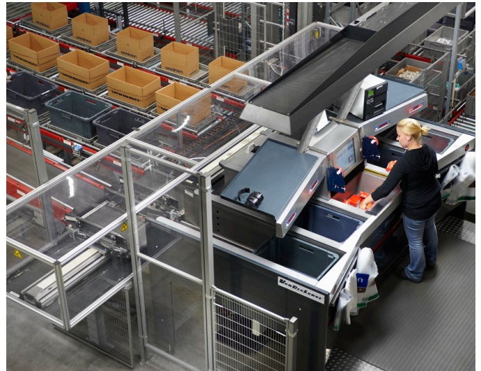
Estación de picking sistema "Producto a hombre". Fuente: VANDERLANDE.
