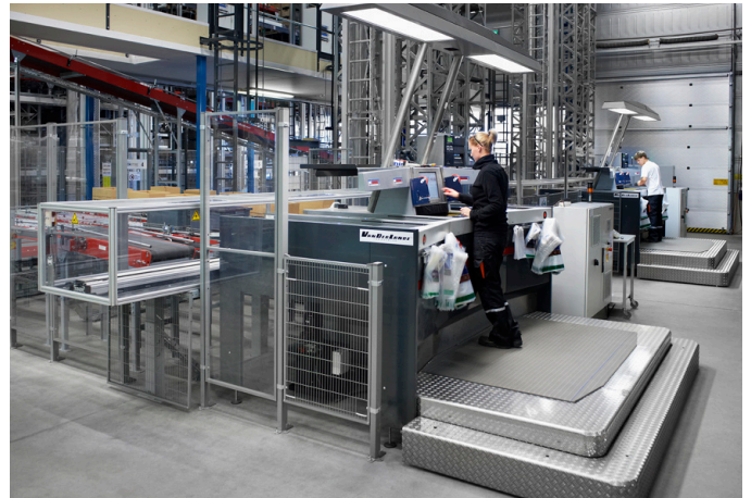
Estación de picking con suelo elevable y regulación de la iluminación. Fuente: VANDERLANDE.
